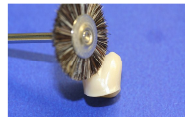
Hochglanzpolitur mit Bürstchen (Bisonhaarbürste) und Polierpaste ca. 5000 U/min
