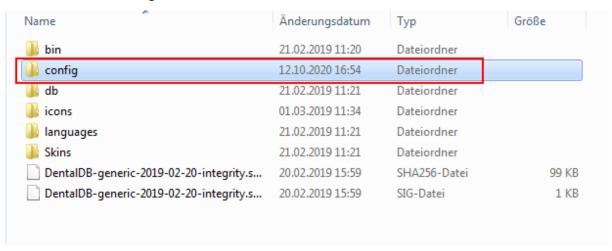
Nun die entsprechende "WorkParamsDB.xml" Datei aus dem Download in den Ordner einfügen und ersetzen
