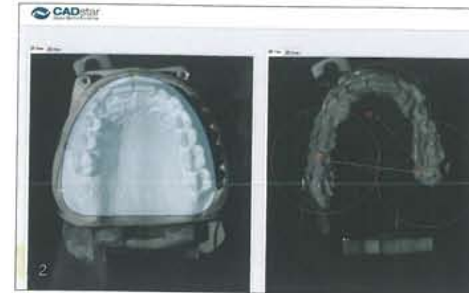
Abb. 2 In einem nächsten Schritt werden das Modell und der Quetschbiss gescannt und die Scandaten mit einer speziellen Software gematcht
