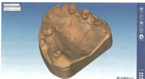
Abb. 1: Darstellung in Farbe. Besonders nützlich für die digitale Herstellung von Modellgüssen ist die Wiedergabe handgezeichneter Markierungen am Modell.
