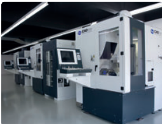
Abb. 1 Fräszentrum: CADstar hat sich auf implantatprothetische Restaurationen spezialisiert und fertigt individuelle Abutments
